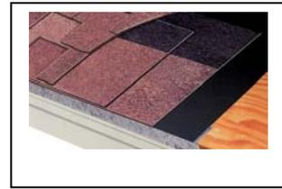
1. **Нижний слой стартового элемента.** Разрежьте первый гонт стартового элемента пополам по длине. Не удаляйте верхнюю перфорированную полосу! Первый кусок половинчатого стартового элемента положите на карниз, выровняйте и прибейте гвоздями примерно на расстоянии 10 см от края карниза. Встык к половинчатой части положите целый стартовый гонт, выровняйте и также зафиксируйте гвоздями. Так продолжайте до тех пор, пока не кончится карниз кровли.
